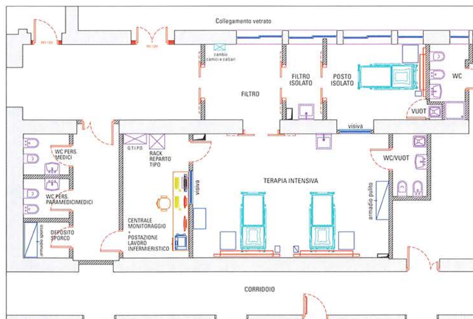
Fig.1 - La planimetria di un reparto di terapia intensiva post-operatoria progettato
