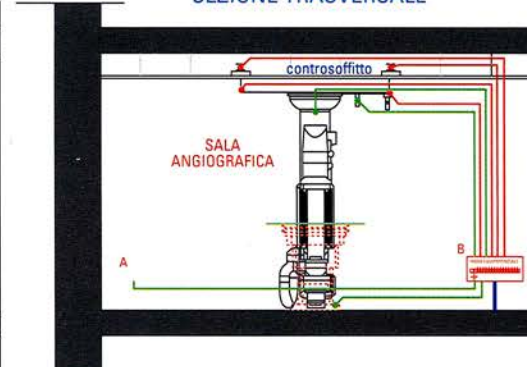
Fig. 3 - L'equipotenzialità realizzata nella sala emodinamica: vista longitudinale e trasversale
