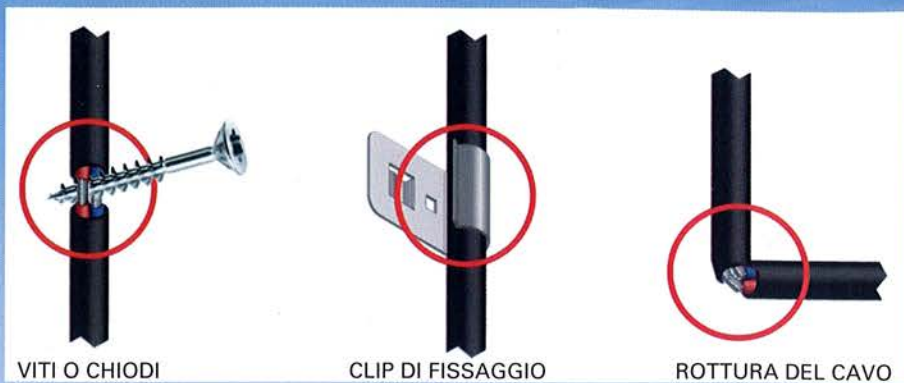
Fig. 1 Alcune anomalie e situazioni pericolose negli impianti elettrici
