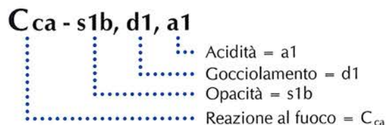
Fig.2 Le classi di reazione al fuoco secondo il CPR
