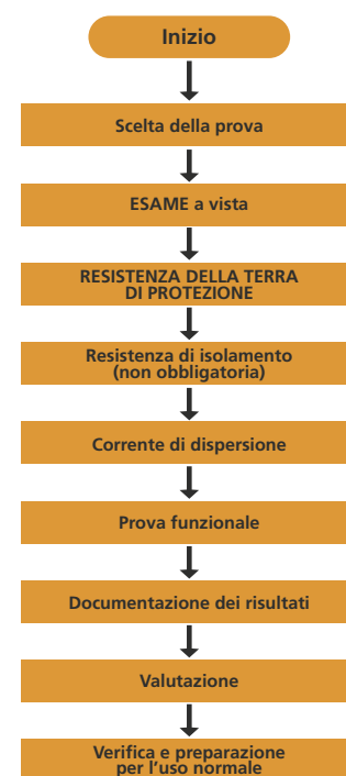
Figura 1. Procedura generale per l'esecuzione delle verifiche (CEI EN 62353)
