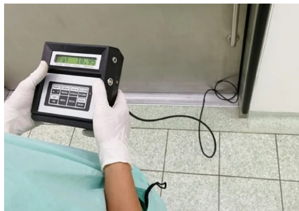
Figura 3. I monitor elettronici posizionati nella stanza d'isolamento e nelle aree esterne a essa offrono un monitoraggio continuo della pressione ivi esistente. Un allarme si aziona se la stanza è erroneamente pressurizzata
